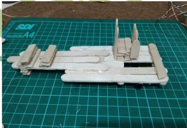
Gambar 4.2 Potongan-Potongan Bahan Yang Telah Dipotong Dan Disusun Menjadi kerangka Mobil
