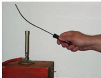
Gambar 2.17 Saat dipanaskan Bimetal Melengkung.
