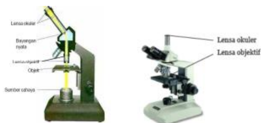
Gambar 2.10. Penampang sebuah mikroskop (Sumber: Contextual Teaching and Learning IPA SMP Depdiknas; IPA untuk SD dan MI)
