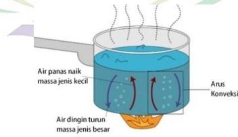
Gambar 2. 10 Perpindahan kalor secara konveksi
