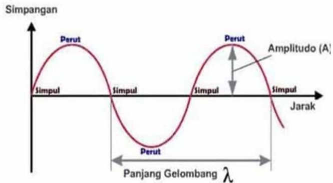
Gambar 2.1 Gelombang Transversal (diambil dari Cutnell & Johnson, 1992)
