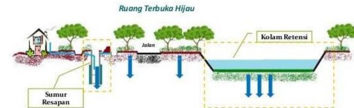
**Gambar 2.2 Ilustrasi Mekanisme Ekodrainase**
