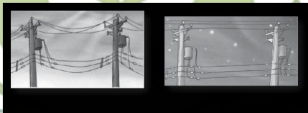
Gambar 2.3. Contoh Pemuaian Panjang Pada Tiang Listrik
