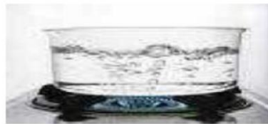
Gambar 2.7. Contoh Perpindahan Panas Secara Konveksi Pada Air Yang Dipanaskan
