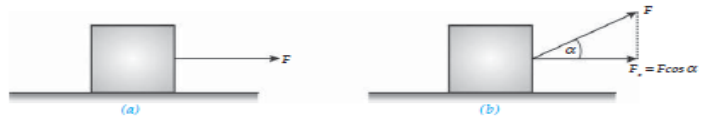
Gambar 2.6 (a) Balok pada bidang datar licin ditarik horizontal (b) Balok pada bidang datar licin ditarik dengan membentuk sudut.
