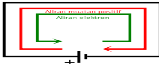
Gambar 2.6 Definisi arus listrik yang mengalir dari kutub positif (+) ke kutub negatif (-) baterai (kebalikan arah untuk gerakan elektronnya) 50
